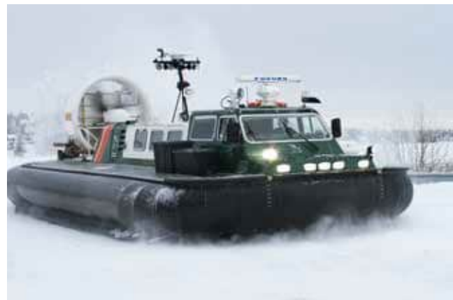
Ilmatyynyalus liikkuu ilmapatsaan kannattamana. Se kykenee miehistön lisäksi kuljettamaan mahdollista hoitohenkilöstöä sekä potilasta.
