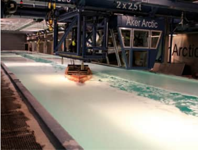
Jo ensimmäisessä vaiheessa tehdään laivan rungolle jäämalli- ja avovesikokeita pienoismallin avulla. Kuva on Turvan pienoismallilla tehdystä jäämallikokeista. Kuva: Aker Arctic Oy.
