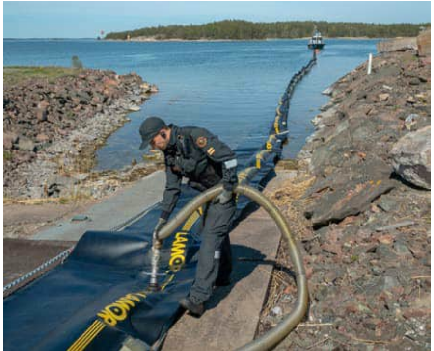
Öljyn rajaamiseksi on erilaisia puomeja. Raskaan avomeripuomin tuuliraja on noin 10–12 m/s.
