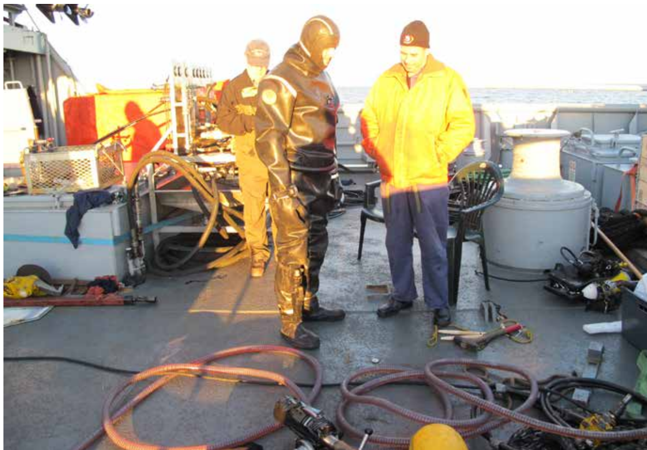
Jut'n Feldtmann hylyn tyhjennys. Etualalla pora, jolla tehtiin reikä tankkiin ja muoviviletu, jossa virtaa hylystä pumpattua polttoainetta. Taustalla projektijohtaja Uljas Hietapakka (SYKE), etuoikealla Merikarhun konepäällikkö Kari Saarela ja sukelluspuvussa Merikarhun perämies Arthur Heickell. (Kuva: Raja).
